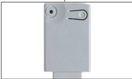
4 kanálový přijímač zapojený do slotu
