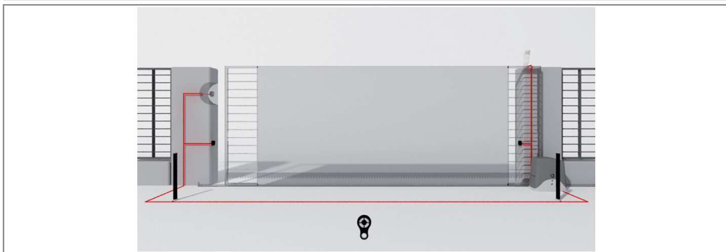
obr. 3 SK - Základová doska
